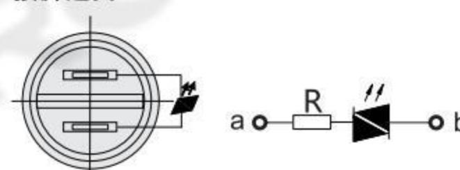
注：采用交直通用的LED灯珠，接线端子无正负极区分；灯珠内置保护电阻，不需外接。
